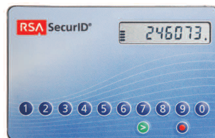
RSA SecurID SID900 zur Signatur von Transaktionen. Das PIN-Pad ermöglicht die Implementierung der digitalen Signaturfunktion.
